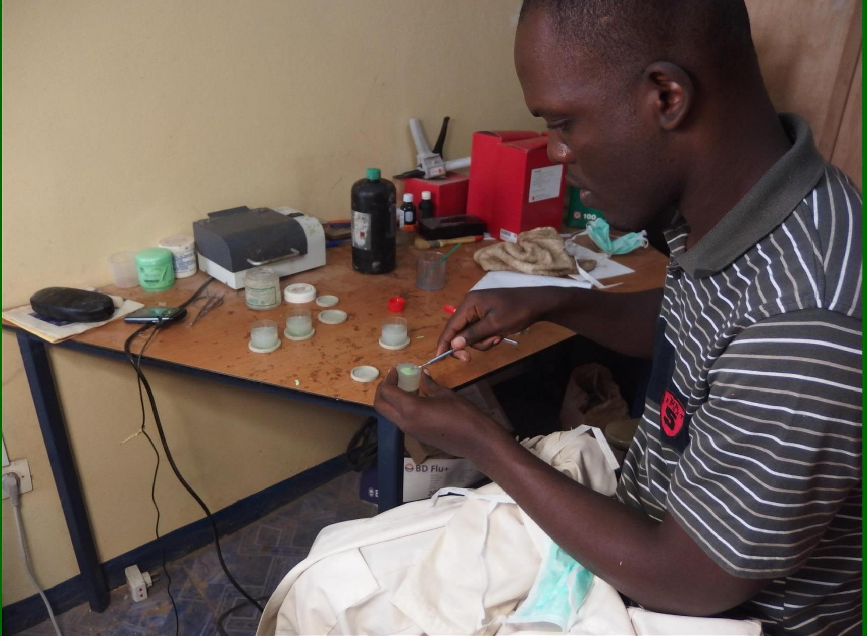
**L'embout préformé est placé dans un petit pot rempli de matériel liquide**
